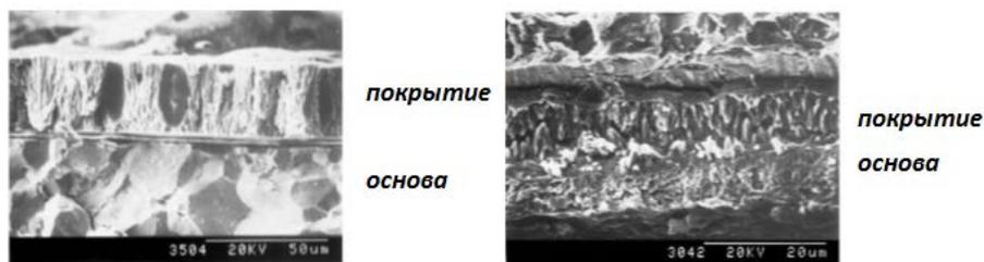
Рис. 1.17. Микрофотографии просвечивающей электронной микроскопии (ПЭМ) поперечных сечений нормального медного покрытия и композитного покрытия медь/микрокапсула на поверхности углеродного электрода.
